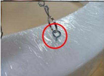
6. Placez la lampe ronde suspendue sur une surface plane. Il y a 4 petits trous pré-perçés autour de la lampe. Vissez une vis à œil, attachée à la chaîne, dans chaque trou. Cela peut être fait à la main. Ne vissez pas complètement la vis dans la lampe, vissez-la juste assez pour que le filetage disparaisse dans la lumière en anneau.
