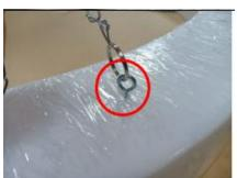
6. Placez la lampe ronde suspendue sur une surface plane. Il y a 4 petits trous pré-percés autour de la lampe. Vissez une vis à œil attachée à la chaîne dans chaque trou. Cela peut être fait à la main. Ne vissez pas complètement la vis dans la lampe, vissez-la jusqu'à ce que le niveau du filetage disparaisse dans l'anneau lumineux.
