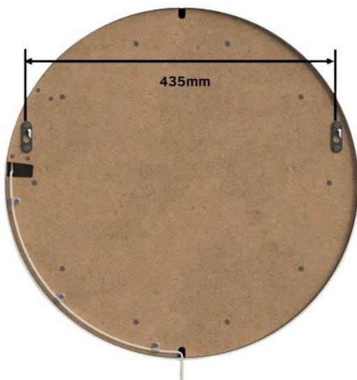
Au dos du panneau, vous trouverez deux supports de suspension. Ils sont espacés de 435 mm (centre à centre). Il suffit de visser 2 vis dans la surface de montage souhaitée, à la distance correcte, et de suspendre le panneau en place.
