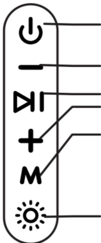
Bouton marche / arrêt : Allumer. Appuyez pendant 3 secondes sur le bouton pour éteindre. Si l'appareil n'est pas utilisé pendant 30 minutes, il s'éteindra automatiquement
