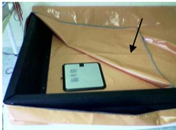
A l'aide d'un cutter, faites une encoche dans un angle de la housse en PVC pour la sortie d'alimentation de la plaque chauffante (veillez à ce que l'encoche soit du côté de la prise électrique). Cette encoche doit être aussi large que la plaque chauffante. En cas de panne de cette plaque, il sera plus facile de la retirer en la faisant passer par cette encoche.
